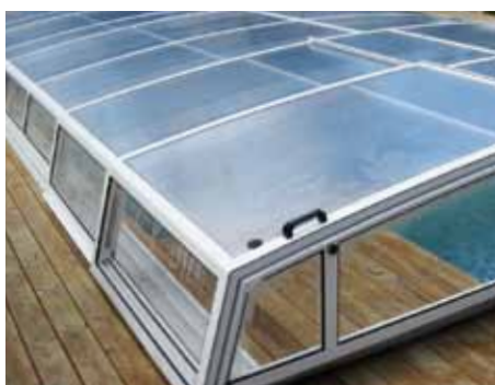
Orfea med skjutdörr vänster på största taksektionen. Taktäckning med kanalplast PC 10 mm, gavlar i glasklar PC, 4 mm.
